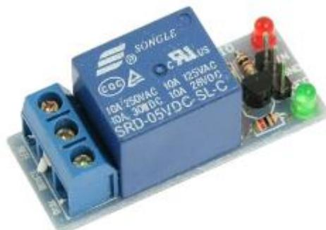
Relay adalah aktuator yang sering digunakan dalam aplikasi otomasi dan kontrol untuk mengendalikan beban listrik dengan sinyal dari mikrokontroler atau sistem kontrol lainnya.
